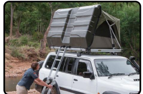
2. i) Klettern Sie die Leiter hinauf, um das Dach zu öffnen, schieben Sie das Dach sanft nach oben. Die Hydraulik unterstützt Sie dabei.
