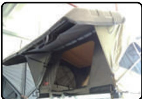
**SCHRITT 5:** Um Ihr Zelt manuell zu falten, trennen Sie einfach die beiden Seitenleisten, ohne Schritt 3 zu durchlaufen.
