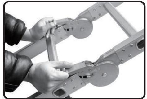
3. c) Einmal entriegelt falten Sie die Leiter in der Hälfte, falten Sie sie nach unten und positionieren Sie sie auf dem Dach.
